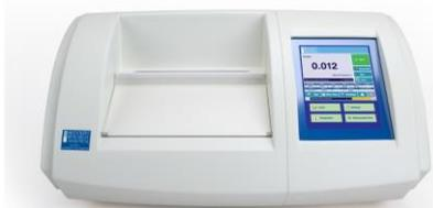
Модель начального уровня. Стандартная точность при измерении оптического вращения составляет  $\pm 0,01$  градуса. Такая точность вполне достаточна для учебных и большинства пищевых лабораторий. Однако, надо отметить, что **Autopol I** не предназначен для решения ответственных аналитических задач в области фармацевтики и не сопровождается пакетом документации IQOQ (*Installation Quality Operation Quality*)
